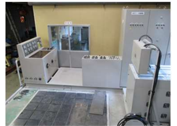
大型モーター用 無負荷試験設備
